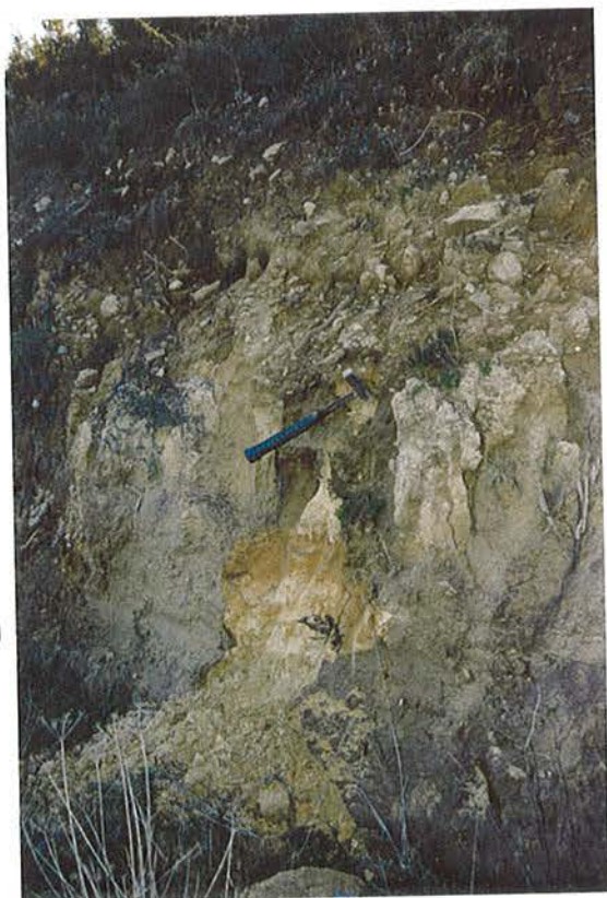
FOTO 5 - GRANITO-ORTOGNEIS COMPLETAMENTE METEORIZADO
