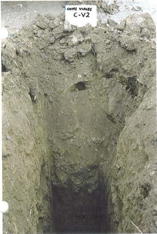
↖ ↗ Fotos 3 y 4 : CALICATA-V2 Y MATERIAL EXTRAIDO
