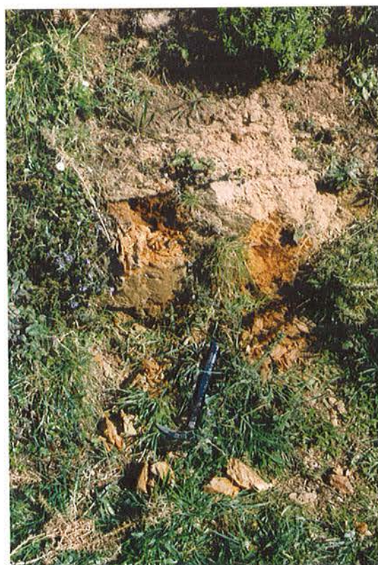
FOTO 32 - AFLORAMIENTO DE PARAGNEIS - MICAESQUISTO MUY METEORIZADO
