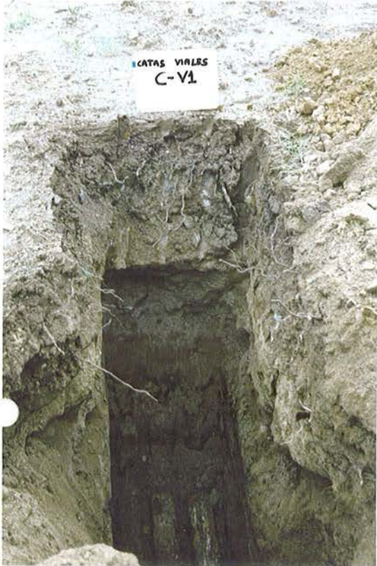
↖ ↗ Fotos 1 y 2 : CALICATA-V1 Y MATERIAL EXTRAIDO
