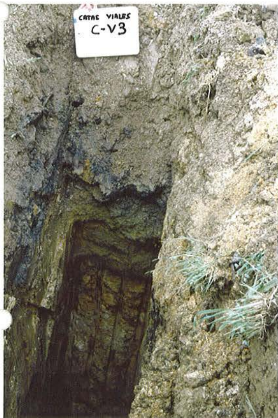
↖ ↑ Fotos 5 y 6 : CALICATA-V3 Y MATERIAL EXTRAIDO
