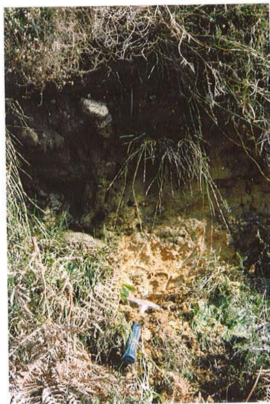
FOTO 30 - GRANITO-ORTOGNEIS COMPLETAMENTE METEORIZADO
